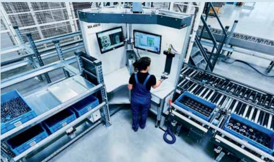
Abb.: Eine Mitarbeiterin prüft mit Hilfe einer KI-basierten Kamera den Reinigungszustand von Operationsbesteck (Foto: Michael Hochfellner, ivii GmbH Vision Systeme).
