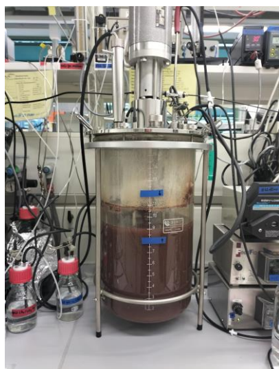
In diesem Bioreaktor wachsen Methan-abbauende Mikroorganismen unter Ausschluss von Sauerstoff für Umwelt- und Industrieanwendungen.
