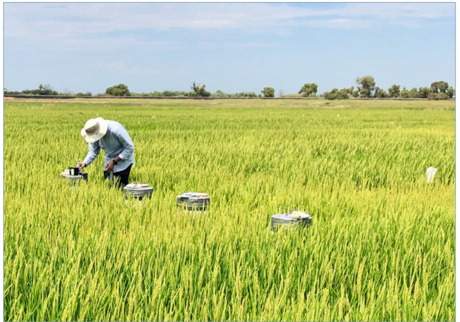
▲ Abb. 2: Aktuell laufender Feldversuch in einem Reisfeld in den USA, in dem versucht wird, die Abundanz und Aktivität der Kabelbakterien zu stimulieren. Im Bild zu sehen sind vier Messkammern zur Bestimmung der Methanemissionen verschiedener Behandlungen.
